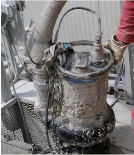
**Les pompes agitatrices Tsurumi** sont équipées de pièces d'usure réglables en fonte dure et de vitesses de pointe réduites, optimales pour les applications les plus agressives.
