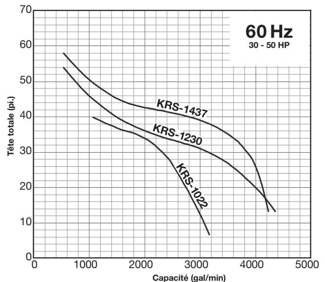
**La série KRS** offre une durée de vie plus longue des pièces grâce à la vitesse plus lente de l'extrémité de l'impulseur fournie par les moteurs 4 pôles, 1800 RPM / 6 pôles, 1200 RPM. La réduction de la vitesse de l'impulseur prolonge la durée de vie des pièces d'usure d'au moins 2 à 3 fois.
