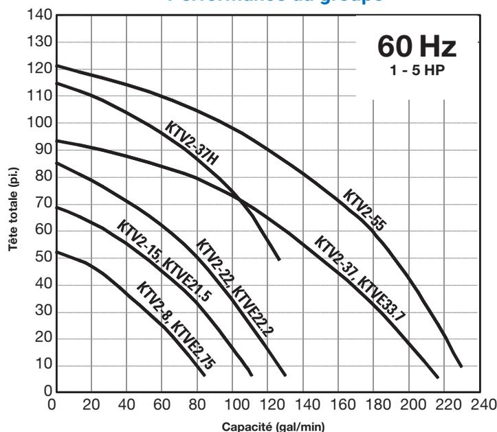
**La série KTV** est construite avec un boîtier en aluminium moulé sous pression et une extrémité de pompe en élastomère pour réduire le poids et permettre une manipulation aisée. L'impulseur semi-vortex permet un passage maximal des particules tout en augmentant la durée de vie des pièces et en éliminant les réglages fastidieux de l'impulseur.
