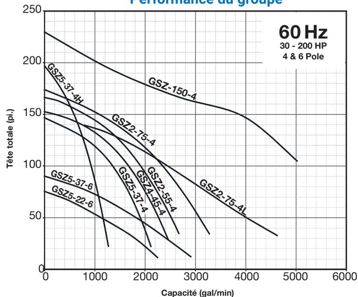
**La série GSZ** est l'une des plus formidables pompes submersibles d'assèchement à haut volume disponibles sur le marché. La réduction de la vitesse de rotation de l'impulseur prolonge la durée de vie des pièces d'usure d'au moins 2 à 3 fois. Avec des matériaux d'impulseur en chrome élevé et en acier inoxydable, la série GSZ s'attaque aux applications d'assèchement les plus agressives. La conception de l'évacuation latérale permet un passage en douceur des matériaux abrasifs.
