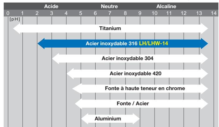
Les données ci-dessus sont une indication approximative pour l'acide sulfurique (H<sub>2</sub>SO<sub>4</sub>) et l'hydroxyde de sodium (NaOH). Les métaux sont affectés par le type d'acide/alcalin, le matériau d'étanchéité, la peinture et l'environnement abrasif.
